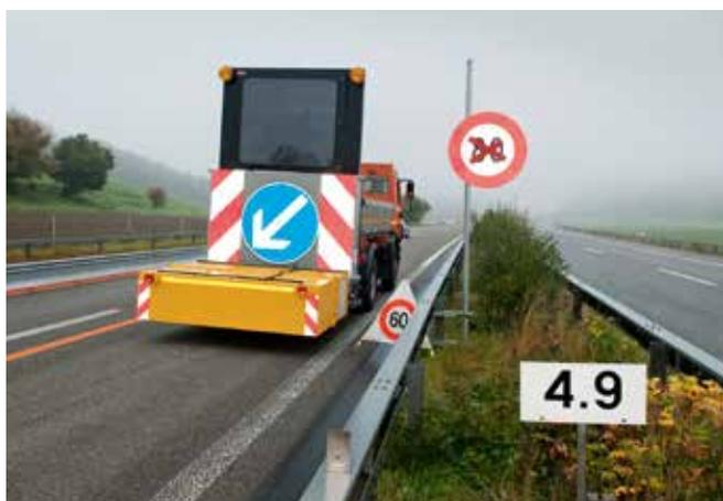
*Dieses Signalisationsfahrzeug verfügt am Heck über einen Anpralldämpfer (gelb).*
